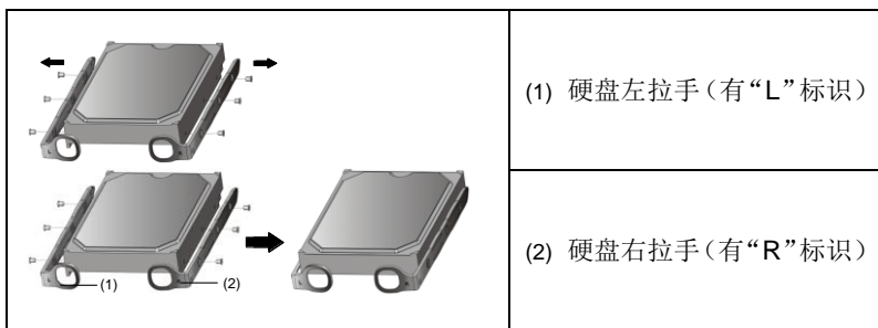
图3-2 拆卸与安装硬盘拉手条
