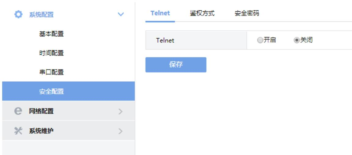
(2) 进入 Telnet 界面, 勾选启用 Telnet 选框, 单击<保存>, 开启 Telnet 远程登录服务功能。
