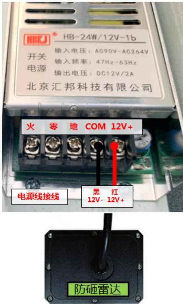
图5-4 配合 DZS 及 DZSG 道闸电源接线
