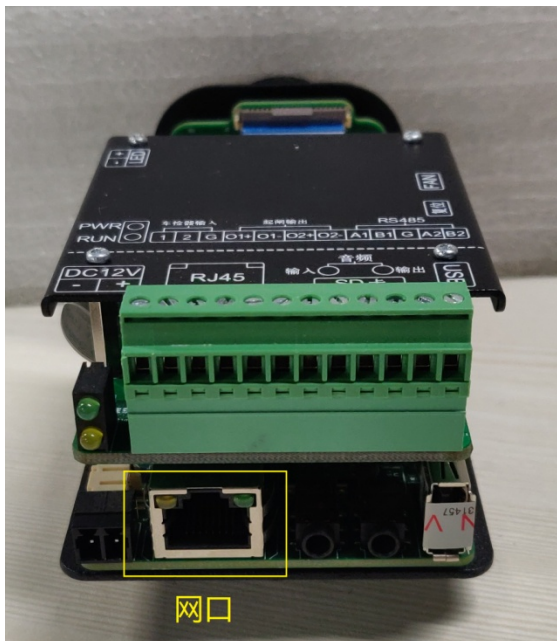
图3-4 网线接线示意图
