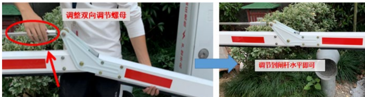
图3-10 曲臂杆平衡调节步骤
