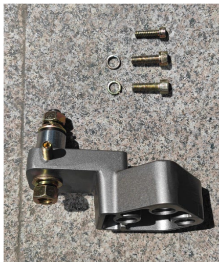
图3-6 拆下机芯固定件
