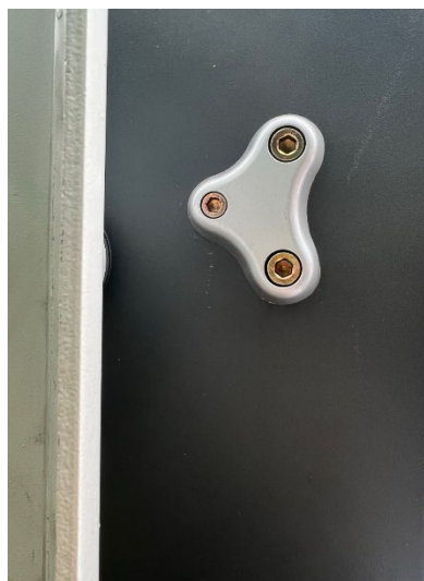
图3-6 拆下机芯固定件
