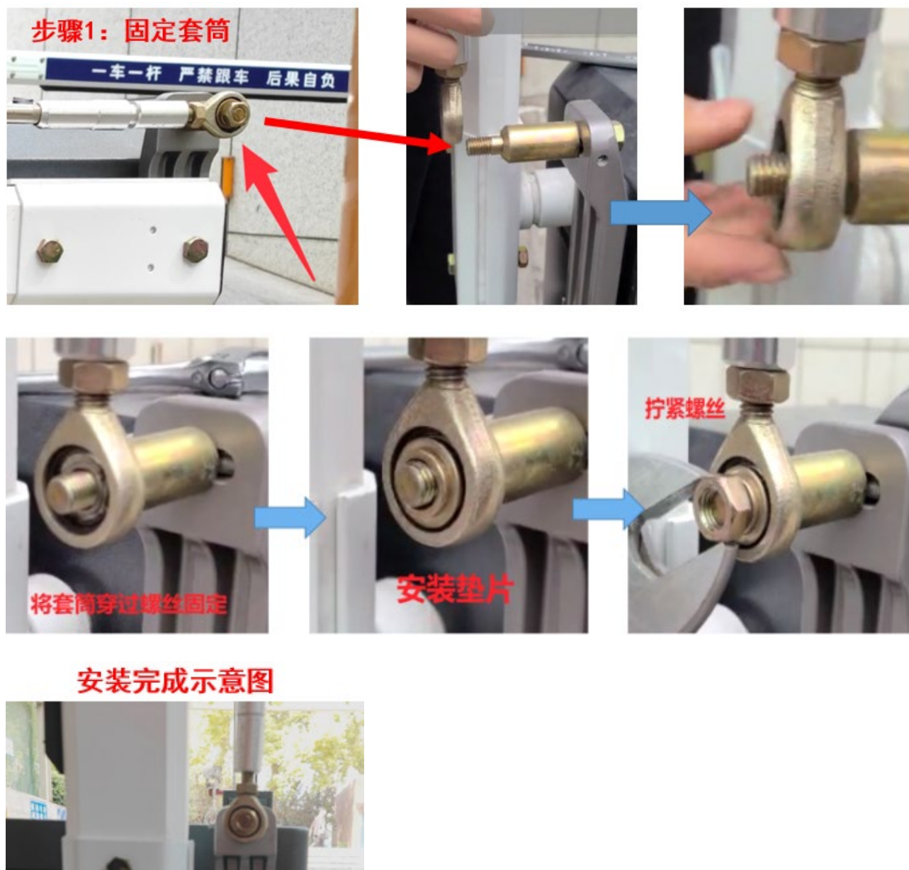
图3-9 曲臂杆牵引杆安装步骤
