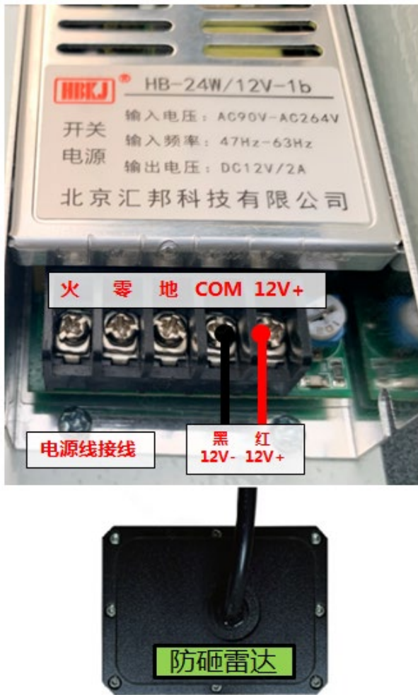
图6-5 配合 DZS 及 DZSG 道闸电源接线
