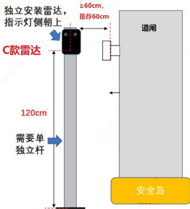
图5-4 C款雷达安装方案示意图
