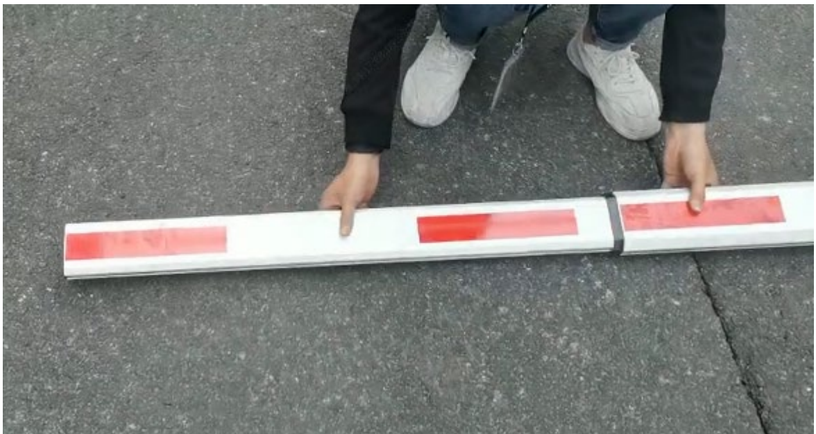
图3-32 杆件长度调节示意图
