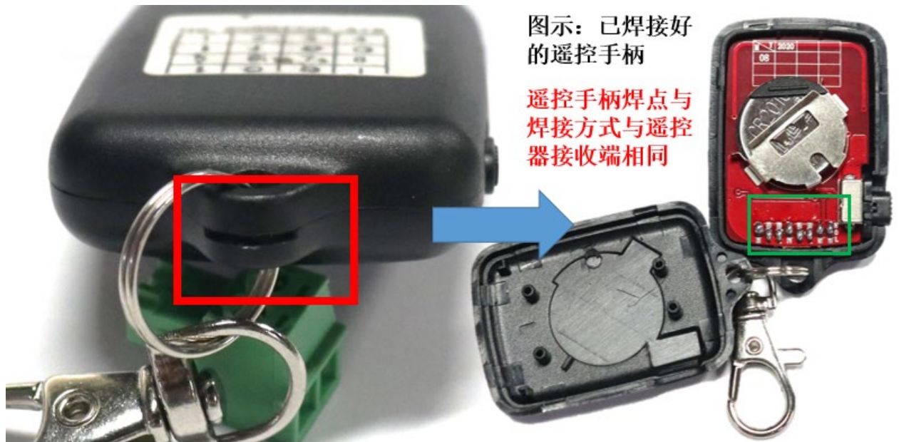
图5-4 拆开遥控手柄进行焊接
