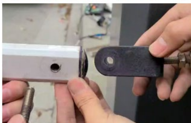
步骤2: 将固定螺丝穿过夹板、垫片和杆件
