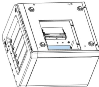
**说明：** Slot1 仅支持 PCIe 接口的 SSD，Slot2 支持 PCIe/SATA 接口的 SSD。
