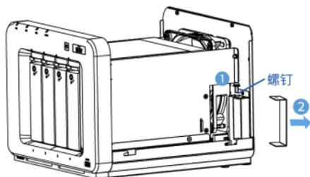
3. 将 PCIe 卡插入主板金手指插槽中，拧入 1 颗螺钉固定。
