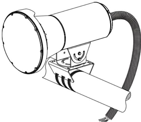
2. 将设备的电源线和安装环境提供的电源线进行可靠连接，并进行防电、防水处理。
