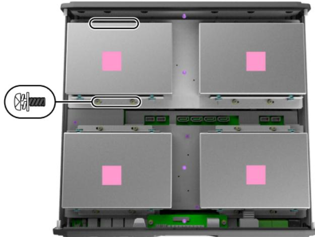
6. 将硬盘按照图示编号分别与对应的数据接口和电源接口连接。
