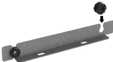
3. 将扁头螺钉穿过防震华司孔洞，拧入硬盘两侧的螺钉孔，将硬盘安装板固定至硬盘两侧。
