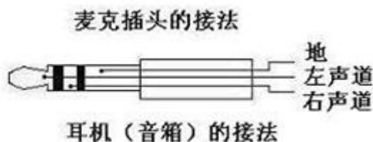
图3-3 3.5mm 音频接口（三芯）连线示意图
