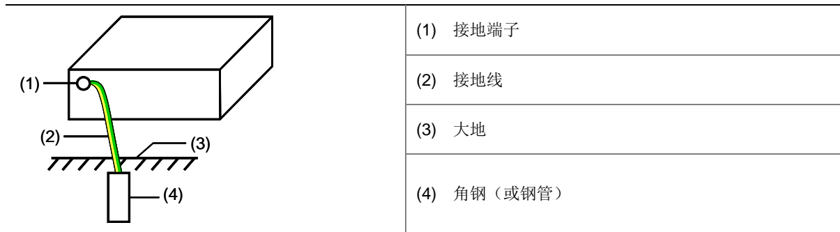
图4-5 接地安装示意图（允许埋设接地体）
