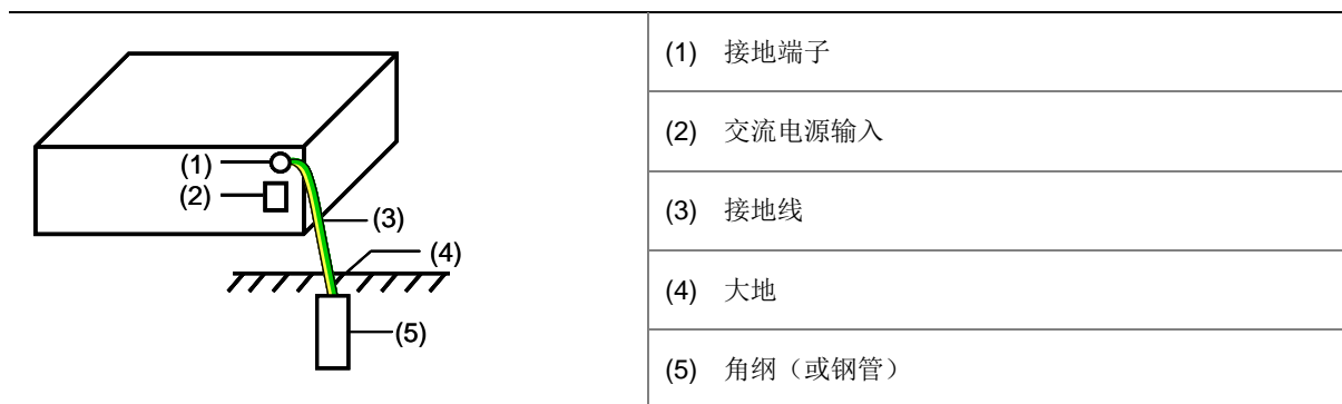
图4-7 接地安装示意图（允许埋设接地体）
