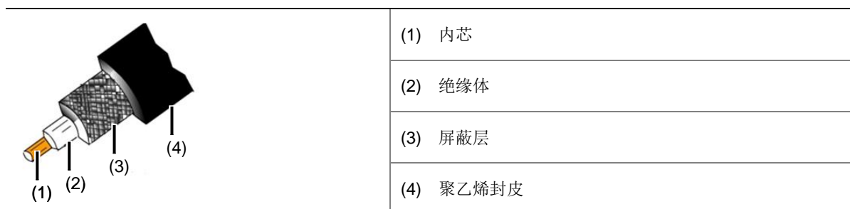
图3-1 同轴电缆示意图
