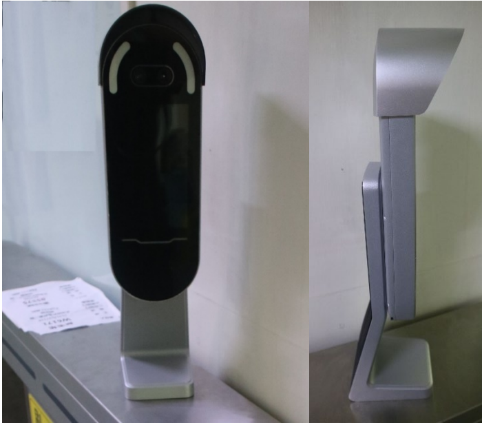
图1-9 遮阳罩安装实拍图
