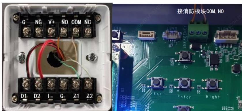
模块无源输出 NO,COM 接闸机 IO 控制板上的 EMERGENCY\_IO
