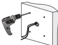
3. 安装膨胀螺栓: 敲击膨胀螺栓, 确认其固定在墙内无松动。
