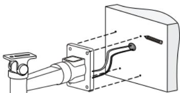
2. 墙壁打孔: 选择与膨胀螺栓外径匹配的钻头, 孔深参考螺栓长度。
