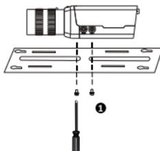
3. 将底板与护罩固定，并通过葫芦孔拧紧 4 颗自攻螺钉。
