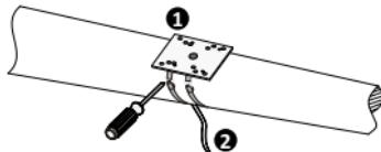
6. 连接电源线和网线。从护罩走线口引入，连接摄像机；将护罩固定在抱箍上，调节万向节和护罩，以调整监控方向。
