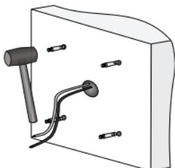
4. 安装支架上墙: 将支架固定到膨胀螺栓, 使用平垫、弹垫和螺母锁紧 (1: 电缆从支架出线口穿出)。
