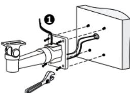
5. 拧上镜头后安装摄像机到支架。
