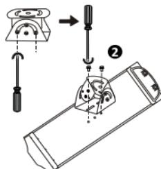
5. 抱箍环绕固定到杆件横臂 (1: 拧紧卡箍，将抱箍固定在横臂上；2: 电缆穿过立杆，从横臂穿出待连接)。
